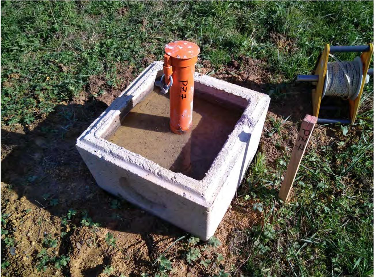
**Figure 2 : Tête de piézomètre sécurisée**
